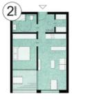
Entlang der Straßenfronten werden alle Wohnungen mit Loggien vorgeschlagen. Diese dienen als schallreduzierende Zwischenzone zu den Schlaf- und können im Bedarfsfall mit Einfachverglasungen schalltechnisch optimiert werden.
